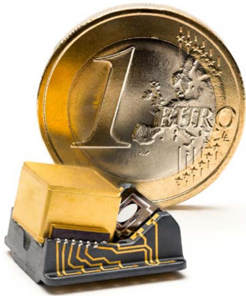
Die laserbasierte Mikroprojektionseinheit „Trixel“ von TriLite Technologies
